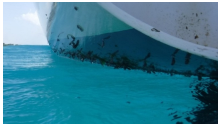
Unterwasserschiff mit Entenmuscheln nach der Atlantiküberquerung
