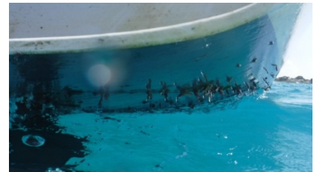
Unterwasserschiff mit Entenmuscheln nach der Atlantiküberquerung
